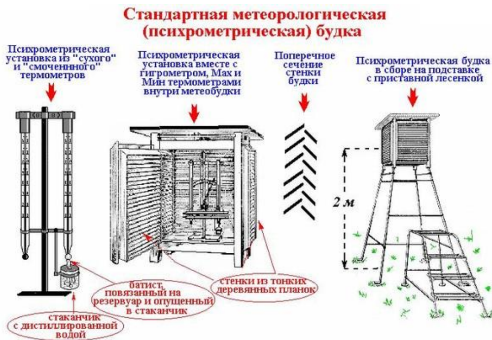
Рис. 3. Психрометрическая будка (общий вид)
